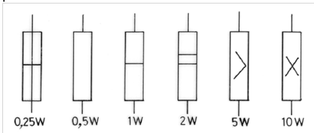
Figura 7-12 Marcarea convențională a puterii nominale a rezistoarelor în scheme electronice
